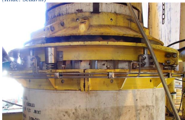
Figur 6: Bilde av ADS montert på West Hercules sin Flex Joint Kilde: Seadrill)
