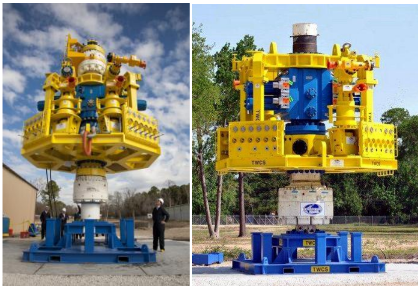
Figur 7: Eksempler på utstyr for tetting (capping)
